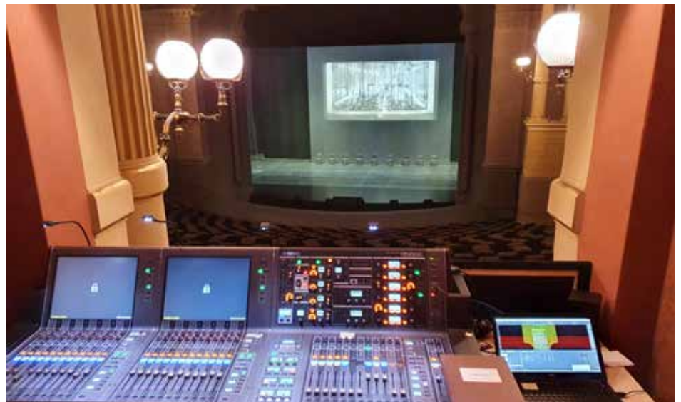
Fernsteuerung der Positionen von Choristen auf der Bühne, von Zuspielderpegel und Filterung der Einzelmikrofone am Mischpult und Notebook
